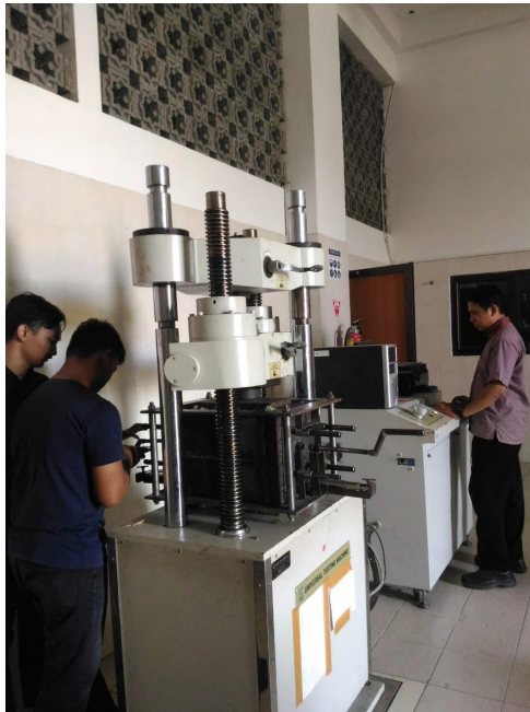
Gambar 3.12. Pelaksanaan Pengujian Tekan Balas dengan alat Universal Testing Machine (UTM) Hung Ta
