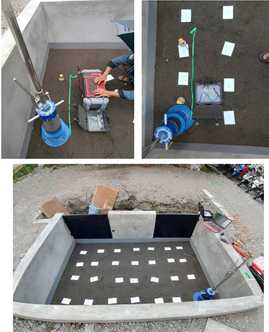
Gambar 4.10. Dokumentasi Pengujian LWD pada Ballast Box
