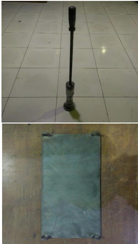
Gambar 3.4. Komponen alat uji berupa penumbuk dan plat baja penahan untuk pendistribusian beban
